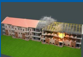
Accumulation des fumées dans les combles
